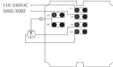
Esquema de cableado para conectar bombas monofásicas de 230 V de más de 1,1 kW (1,5 CV) a través de un contactor de maniobra. / *Wiring diagram to connect 230 V single-phase pumps over 1.1 kW (1,5 HP) through a contactor switching.*
