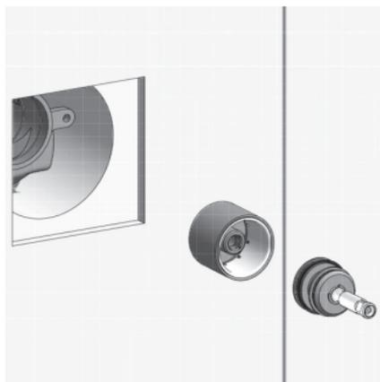
7. Extraiga el conjunto eje-pistón del cuerpo de la válvula.
