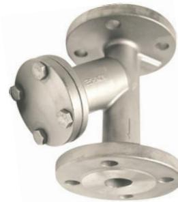
En sistemas de vapor debe evitarse la acumulación de condensados por lo que se aconseja instalar el filtro en posición horizontal con el tamiz en el plano horizontal y la tubería debe tener una ligera inclinación en sentido descendente.
